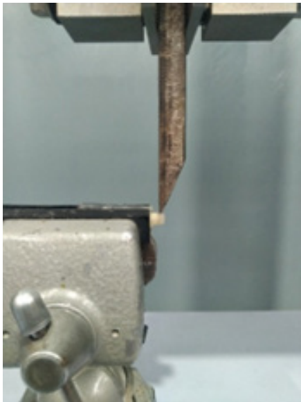
Figura 6. Ensayo de carga a cizallamiento.
