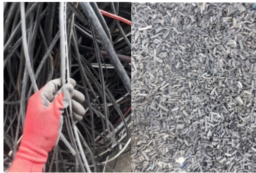
Figura 9. Estructura inicial y final del PVC
