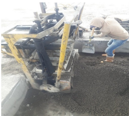
Figura 4. Descripción de la prensa hidráulica
