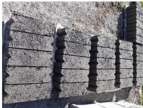
Figura 6. Estructura del eco-blocs
