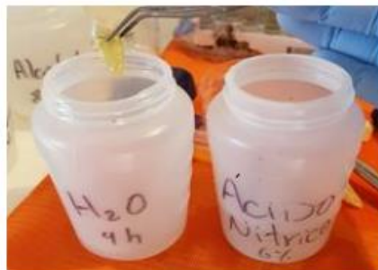
Imagen N° 13. Cambio del ácido al agua
