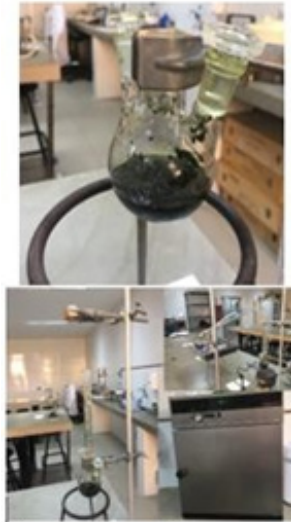
Figura 1. A) y B) Proceso de obtención del extracto acuoso del rallado de la Persea americana a las tres concentraciones mencionadas.
