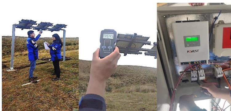
**Figura 11.** Recolección de datos con el piranómetro y multímetro
